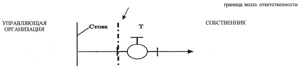
**2. По системе водоотведения:** точка присоединения отводящей трубы системы водоотведения квартиры к тройнику транзитного стояка общедомовой системы водоотведения. Тройник транзитного канализационного стояка и сам стояк обслуживает Управляющая организация, оставшуюся часть – Собственник
